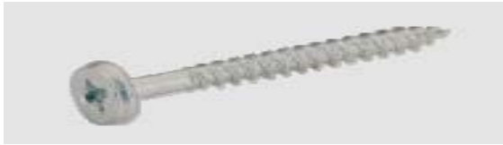
Şekil 1. Deneylerde kullanılan 4 x 50 vida (ölçüler mm'dir)
